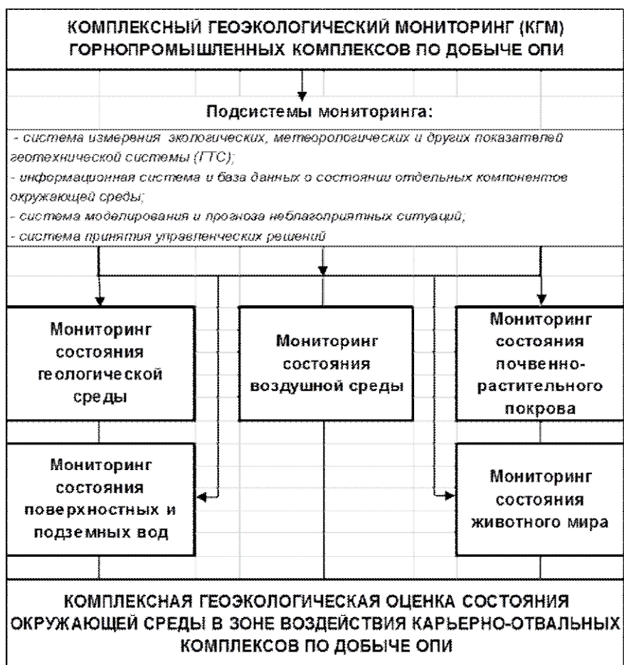
Рис. Структурная схема комплексного геоэкологического мониторинга (КГМ) горнопромышленных комплексов по добыче ОПИ
