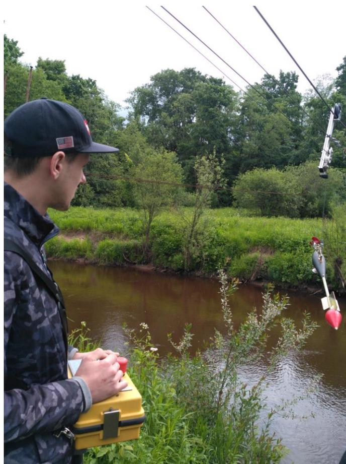
Работа с гидрометрической вертушкой. Река Полометь.
