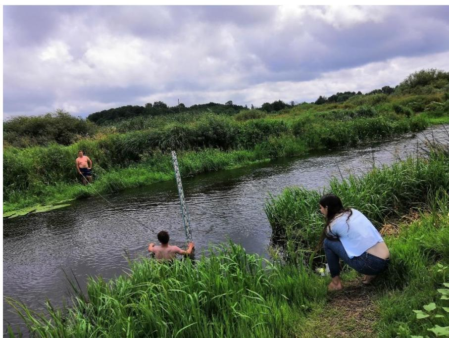
Студенты выполняли измерения скорости течения реки и расхода воды поверхностными поплавками, а также познакомились с гидрометрической вертушкой. После по полученным данным была составлена таблица запуска поплавков.
