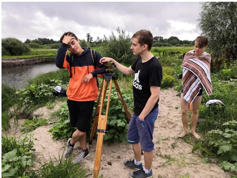
После проводилось нивелирование водомерного поста и промеры русла на поперечниках, разбитых в середине и на концах участка. По измерениям, полученным в ходе работы, составили таблицы данных для построения профиля берегового склона и построения поперечного сечения нижнего, верхнего и главного створов.
