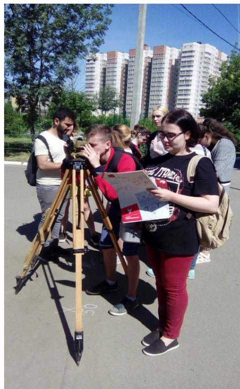
Следующий этап – тахеометрическая съёмка местности. В рамках данных работ студенты научились работать с теодолитом. Был успешно проложен теодолитный ход, определены плановые координаты точек хода, а затем из каждой точки хода при помощи полярной системы координат из каждой точки теодолитного хода измерены угловые и метрические характеристики окружающих объектов.
