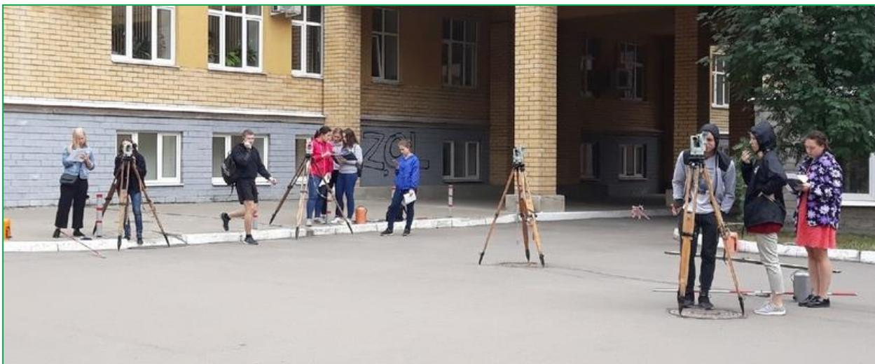
В ходе практики было произведено нивелирование местности – определение высотных отметок точек местности. Итогом нивелирования было построение продольного профиля рельефа.
