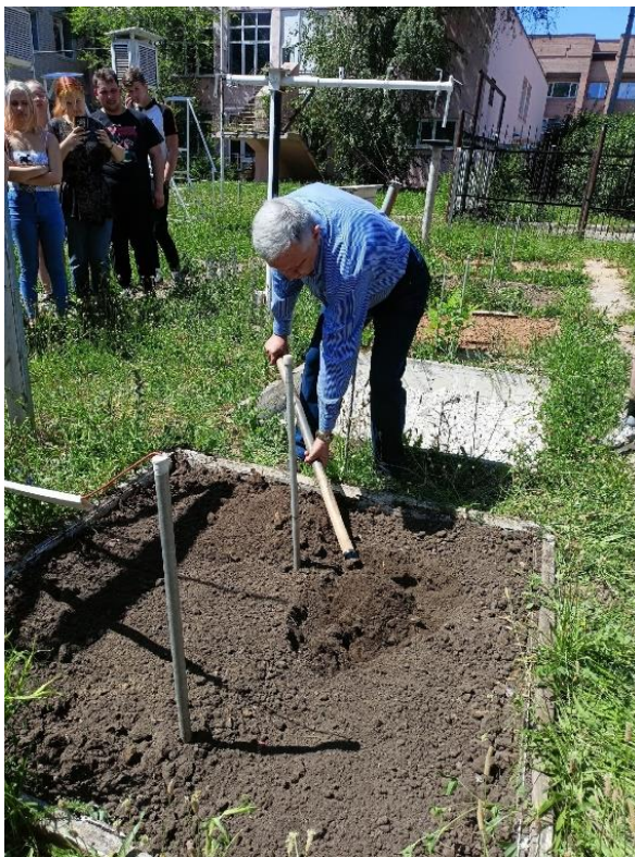
Рис. 5 Установка почвенных термометров
