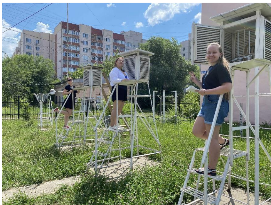
Рис. 6 Снятие показаний с термометров в психрометрической будке
