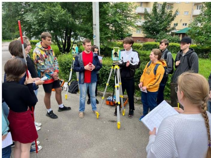
Особое внимание уделено нивелированию, процессу определения высотных отметок точек местности. В результате нивелирования были получены обработанные данные о высотах, которые затем использовались для построения продольного профиля рельефа.
