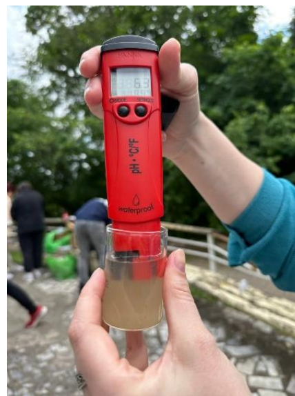
Рис.1. Выполнение анализа воды и почвы в полевых условиях
