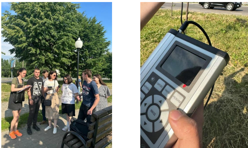
Рис.2 Измерения уровня шума с помощью портативного шумомера
