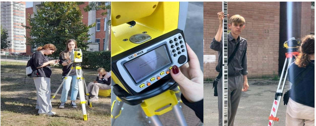
В процессе его использования, была произведена подробная топографическая съёмка территории, прилегающей к учебному корпусу № 5 ВГУ. Итогом работы стал топографический план местности, созданный в специализированных программных средах.
