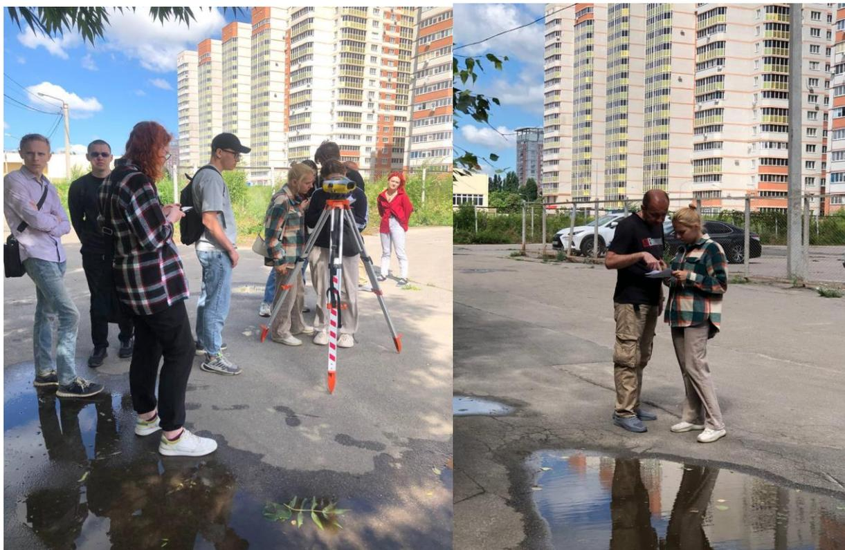
Особое значение было уделено процессу тахеометрической съёмке и нивелирования. В ходе работ были задействованы как оптические, так и электронные нивелиры. Студенты научились определять превышения точек, что не маловажно при любых ландшафтных и картографических работах, а также проложили и уровняли замкнутый нивелирный ход – важнейший вид работ при топографо-геодезических изысканиях.
