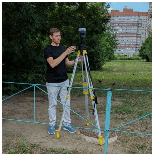
Рис. 2. Определение координат пунктов геодезического съёмочного обоснования.
